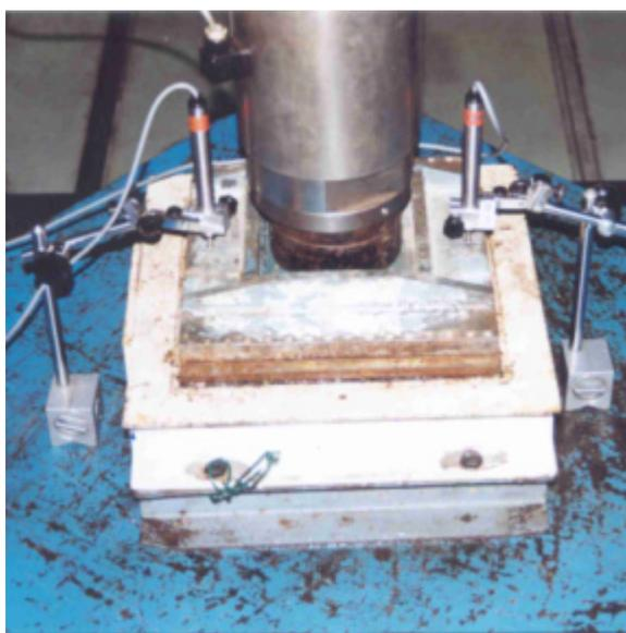
Figura 5.15 - Câmara de compressão unidimensional UNI<sub>30</sub> no Laboratório do CEDEX, Espanha.
