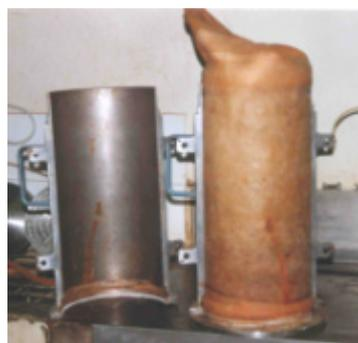
(b) Retirada do molde metálico
