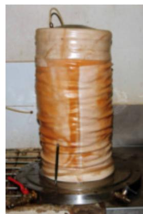
(c) Corpo de prova depois do ensaio
