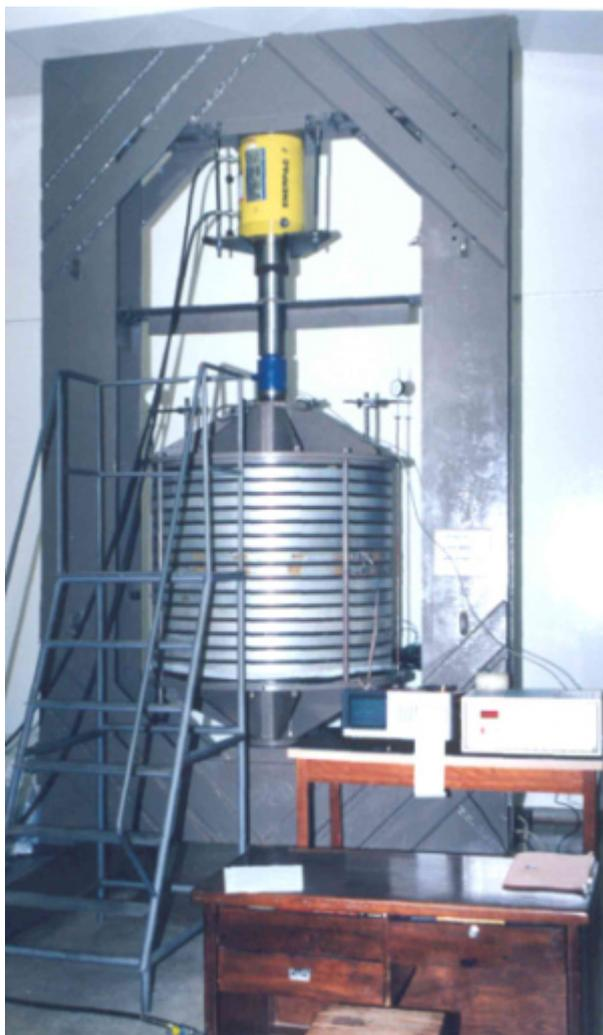
Figura 5.13 - Equipamento de compressão unidimensional de grandes dimensões UNI<sub>100</sub> no Laboratório de Furnas, Goiânia.
