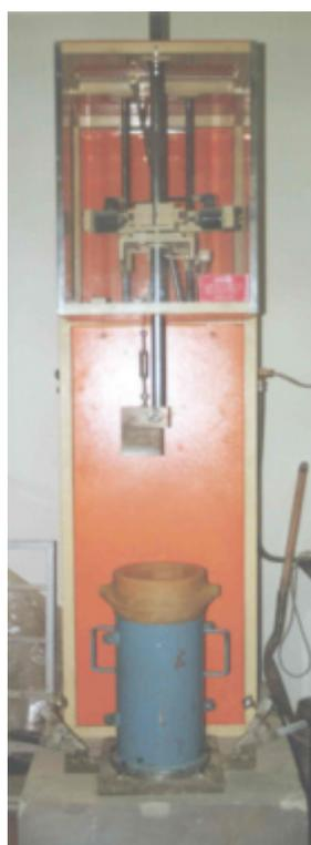
(a) Compactador e molde metálico
