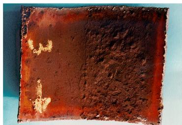
Figura 3.7 – Corrosão interna [28]
