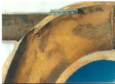
Figura 3.4 – Corrosão – Erosão
