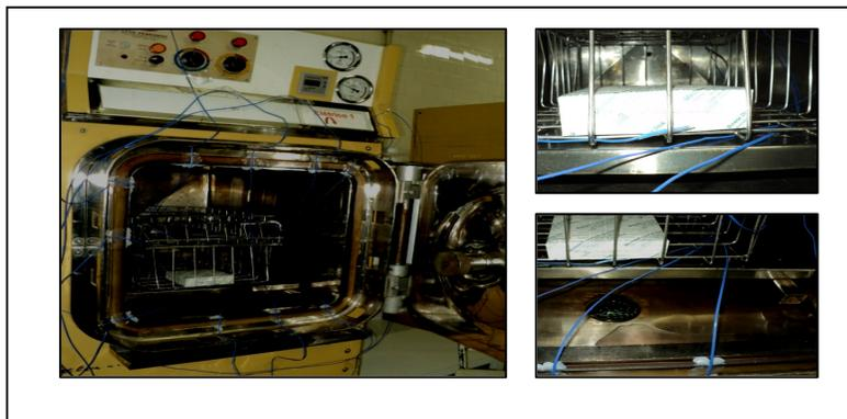
Figura 17 - Distribuição dos transdutores de temperatura na câmara de esterilização E<sub>1</sub> sem carga.
