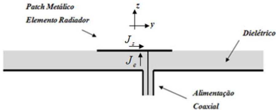
Figura 3.2 – Vista lateral da antena microfita
