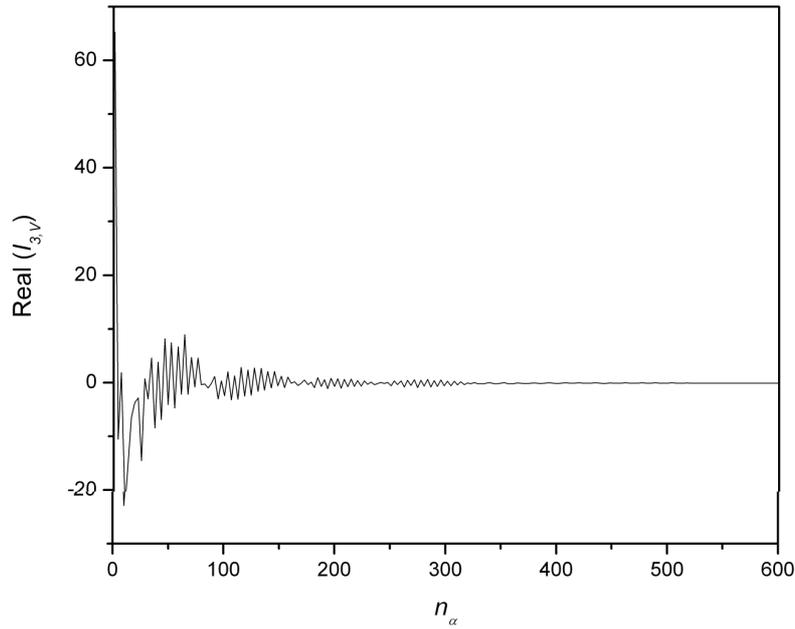
Figura 3.4 – Convergência da parte real da integral  $I_{3,V}$  em coordenadas cartesianas com o número de pontos em  $\alpha$
