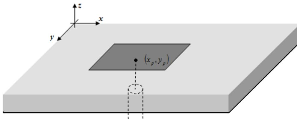
Figura 3.1 – Antena microfita com alimentação coaxial
