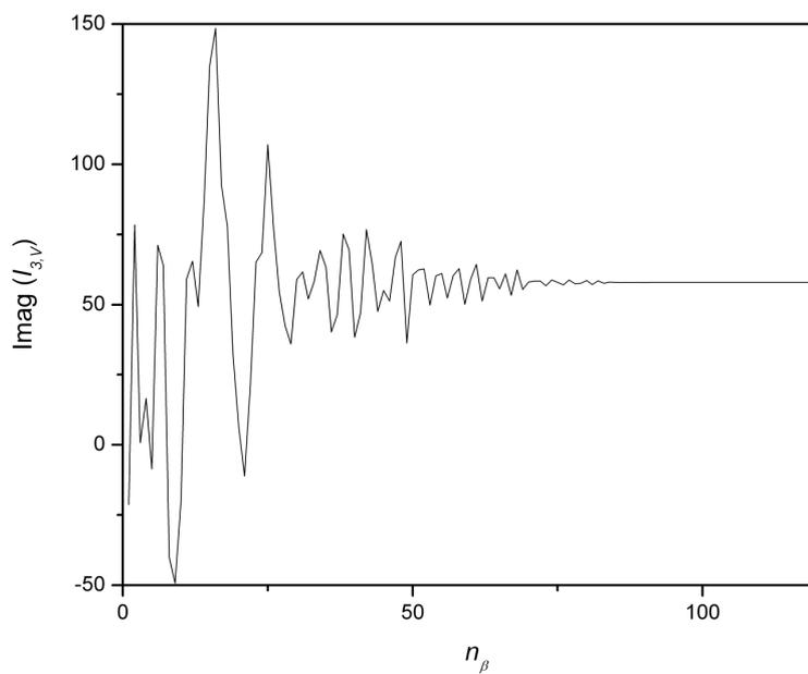
Figura 3.7 – Convergência da parte imaginária da integral  $I_{3,V}$  em coordenadas cartesianas com o número de pontos em  $\beta$
