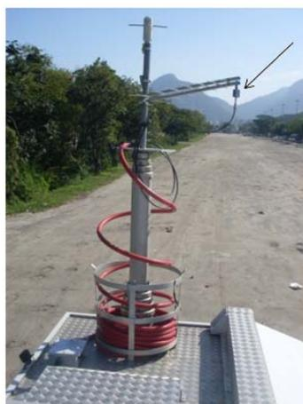
Figura 4.14 Fixação do casador 75/50  $\Omega$  e das antenas junto à haste retrátil
