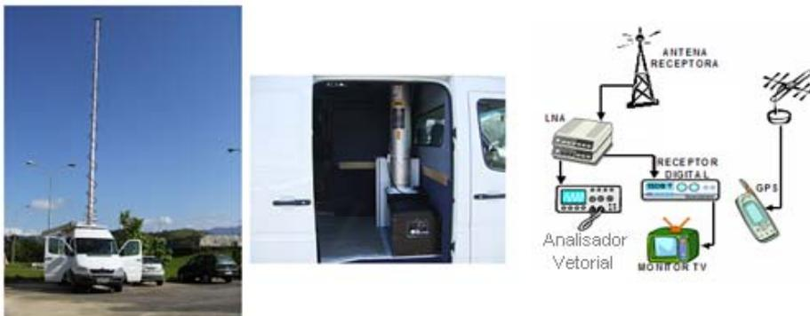
Figura 4.12 Configuração de montagem dos equipamentos de medição instalados na estação móvel de teste
