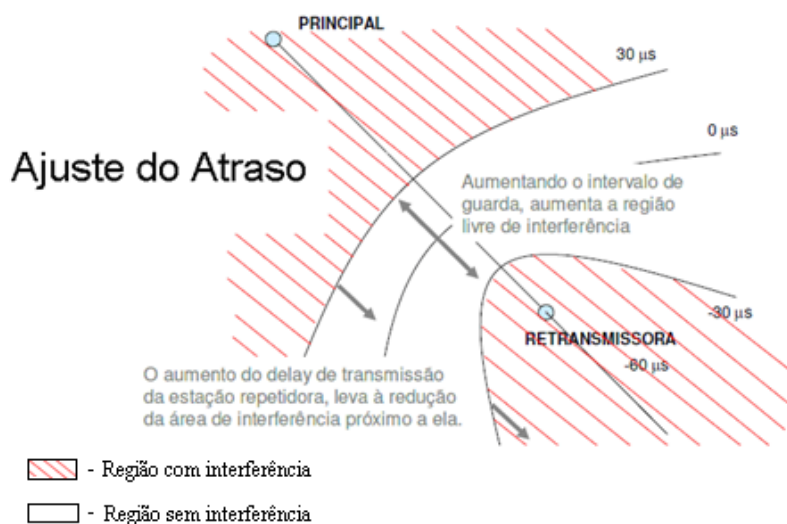
Figura 3.8 Ajuste da região livre de interferência
