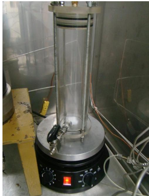
**Figura 48** Foto do cilindro de acrílico sobre o agitador magnético
