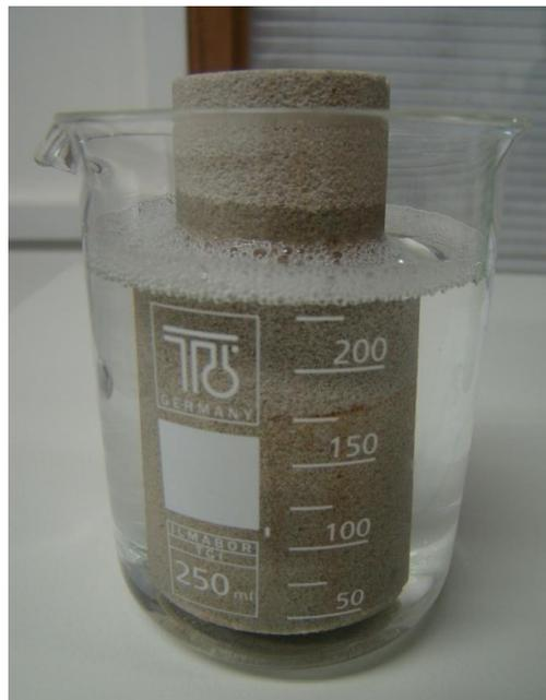
**Figura 27** Amostra preparada para ser saturada
