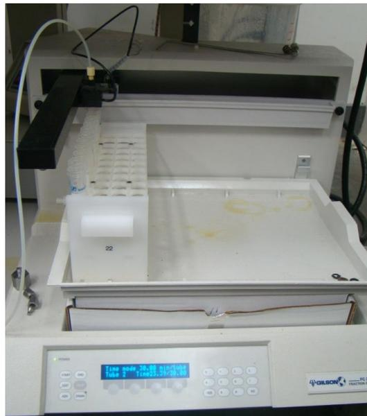
**Figura 32** Coletor de frações: usado para distribuir a produção dos fluidos em pequenos tubos
