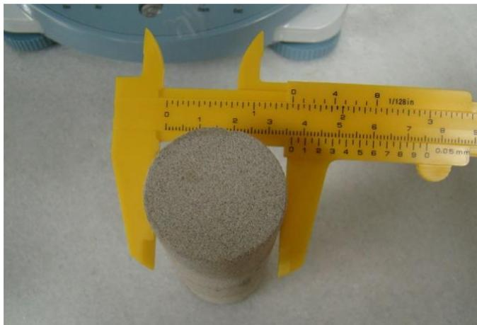
**Figura 35** Amostra de Bentheimer medida com um paquímetro
