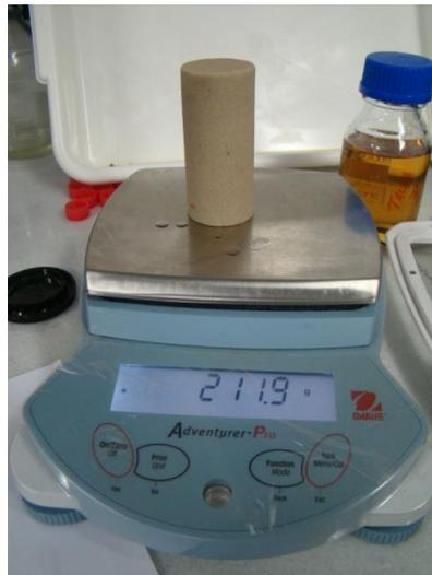
**Figura 30** Amostra pesada após ter sido saturada com a solução salina
