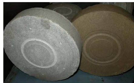
Amostras de mármore e calcário depois do ensaio de cortador único.
