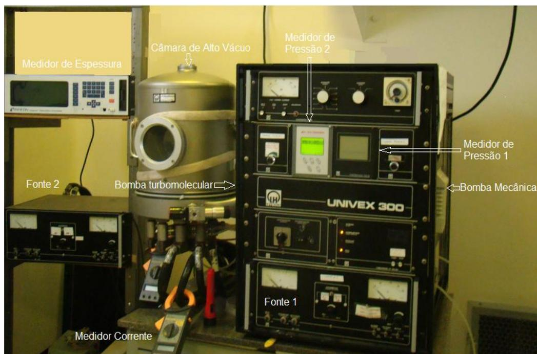
**Figura 4-1** Foto do equipamento de deposição Univex 300.
