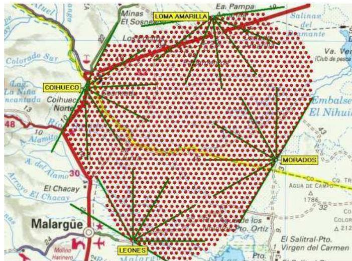
**Figura 3.1:** Disposição dos detectores de superfície (pontos vermelhos) e dos detectores de fluorescência (Leones, Morados, Loma Amarilla e Coihueco) na periferia do arranjo SD, especificamente neste caso mostra-se também o campo de visão de cada um dos telescópios de fluorescência (linhas verdes).
