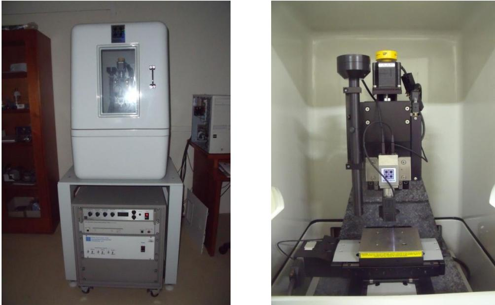
Figura 3.6. Fotografia do Nanoindentador utilizado para as medidas de dureza dos filmes em estudo (a) parte externo do nanoindentador (b) parte interna.
