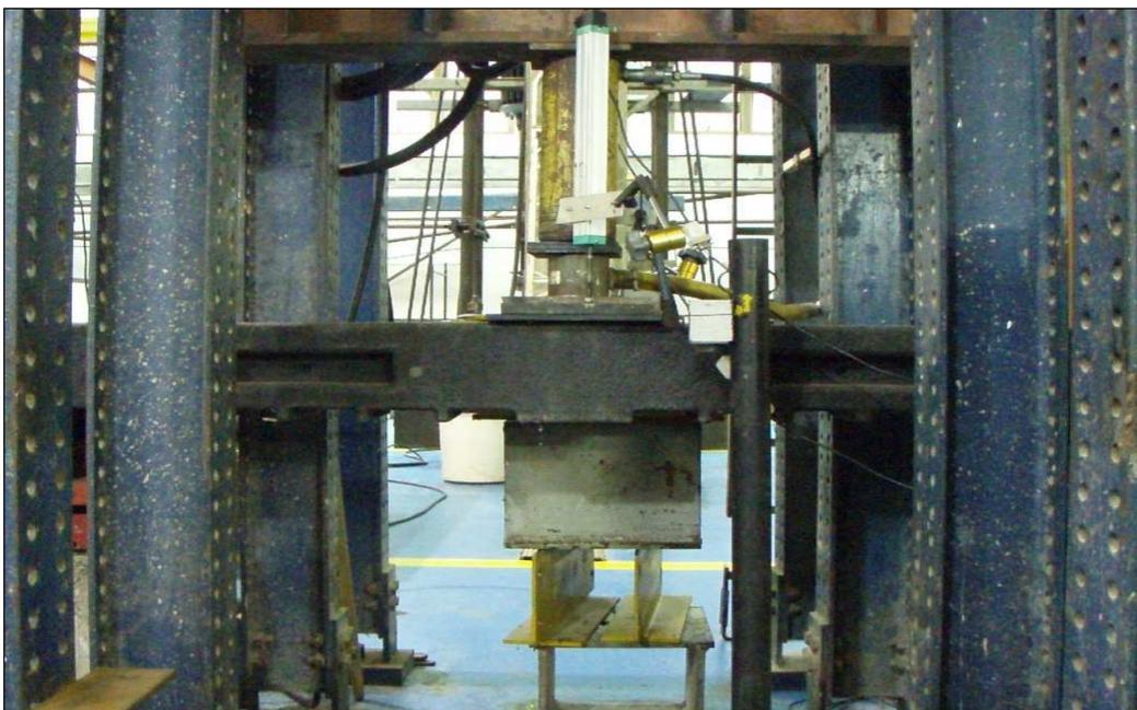
Figura 3-11 Montagem do ensaio no dormente de comprimento de vão de 167 mm.
