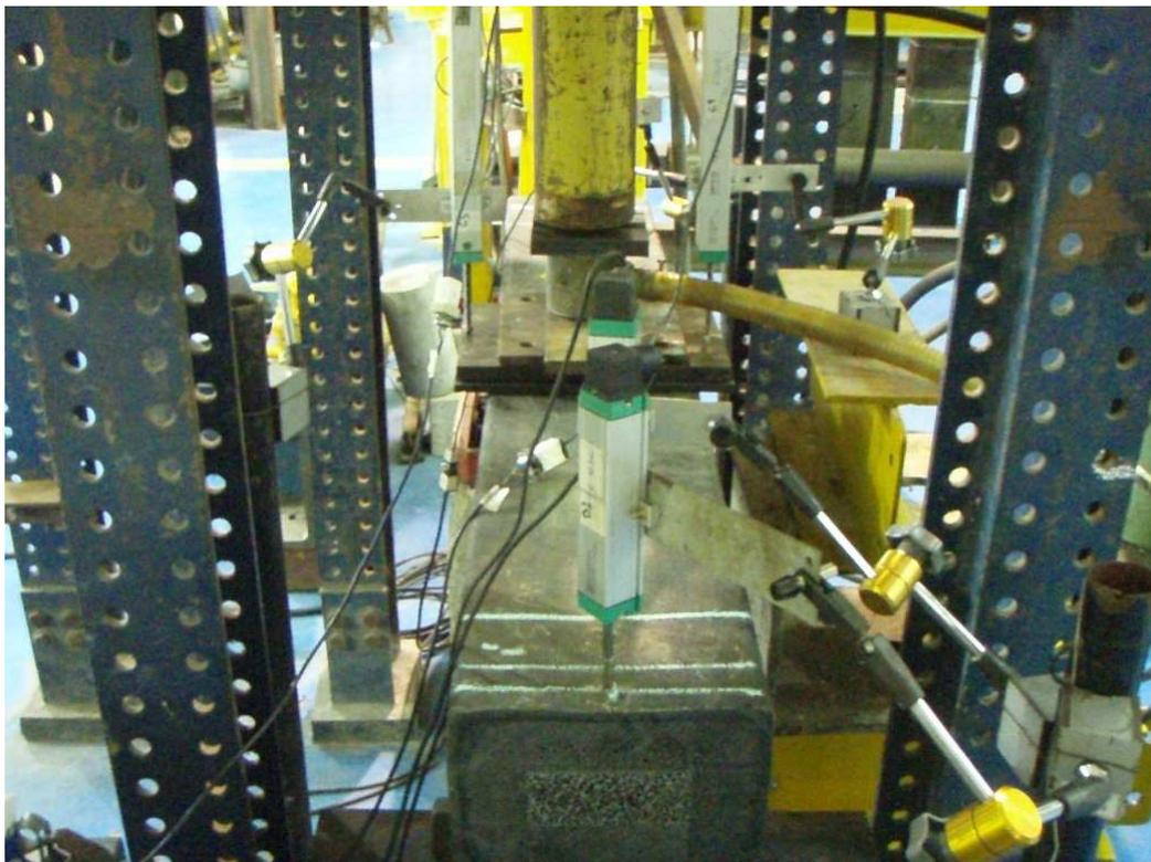
Figura 3-18 Detalhes da instrumentação do ensaio de flexão no dormente D.P.1.1.E.F.1.C.5-1.
