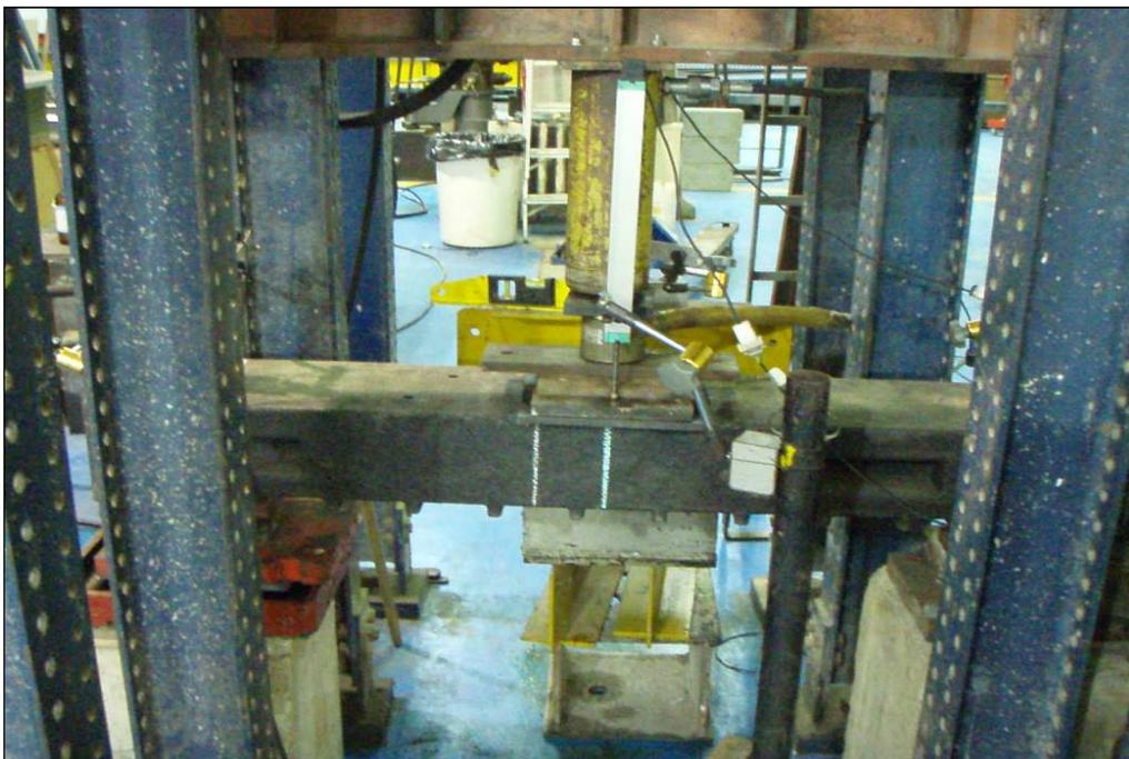
Figura 3-14 Montagem do ensaio de flexão no dormente D.P.2.0.E.F.1.C.5.
