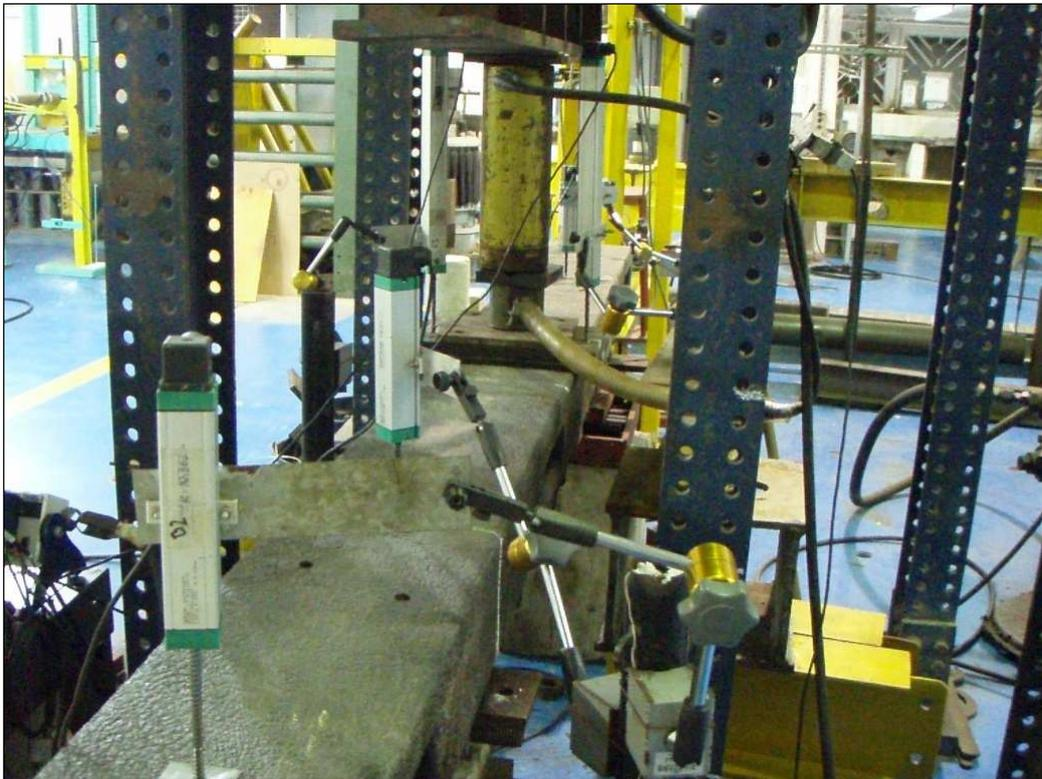
Figura 3-12 Montagem do ensaio no dormente de comprimento de vão de 167 mm.
