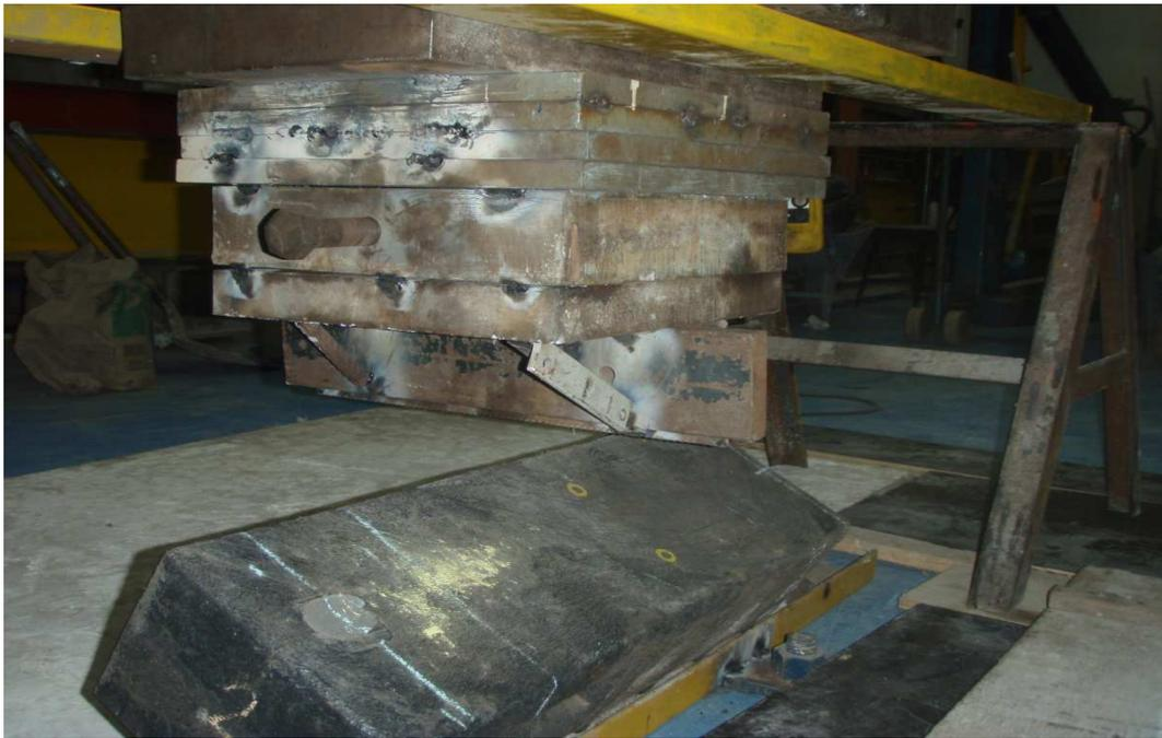
Figura 3-24 Perfil do peso que impactou o dormente no ensaio de impacto.
