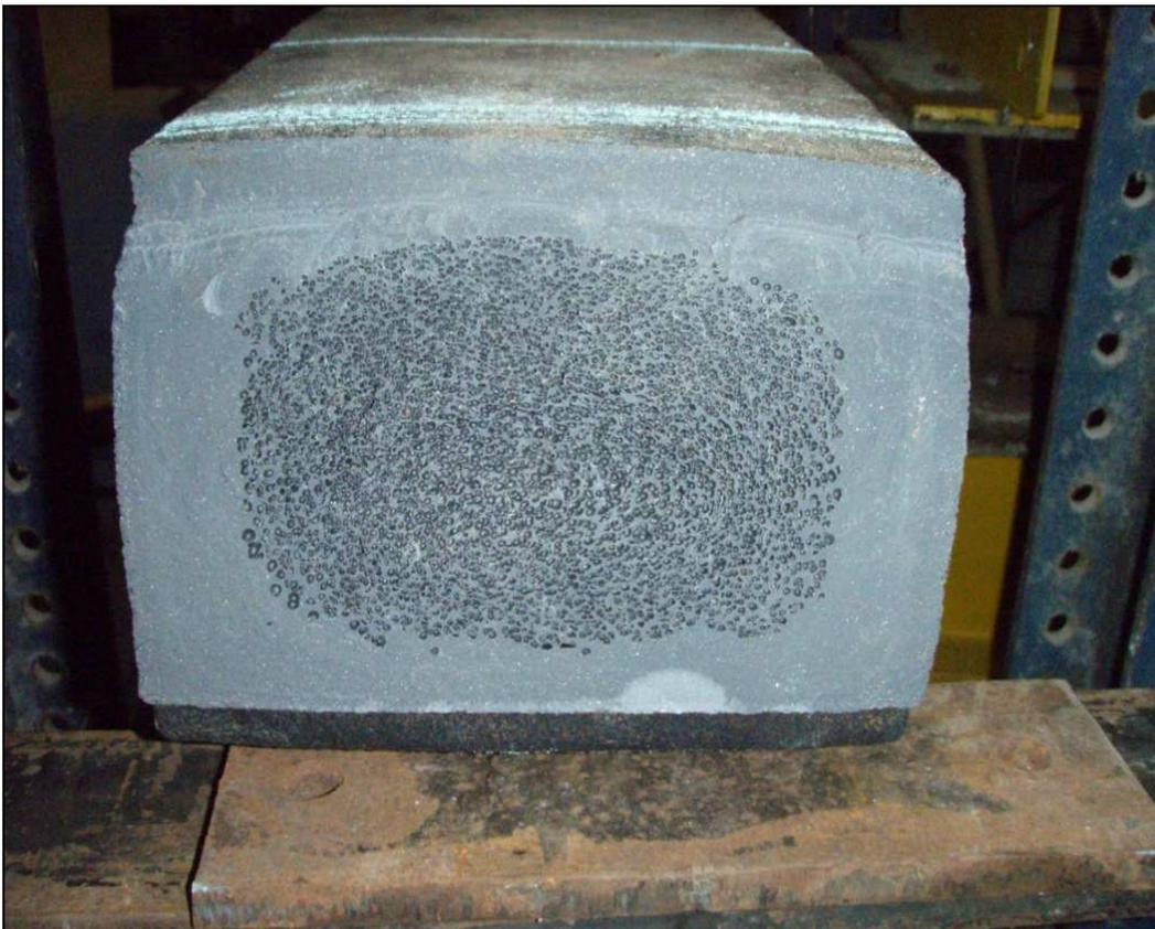
Figura 3-2 Seção transversal de um dormente de madeira plástica fabricado pela Wisewood.
