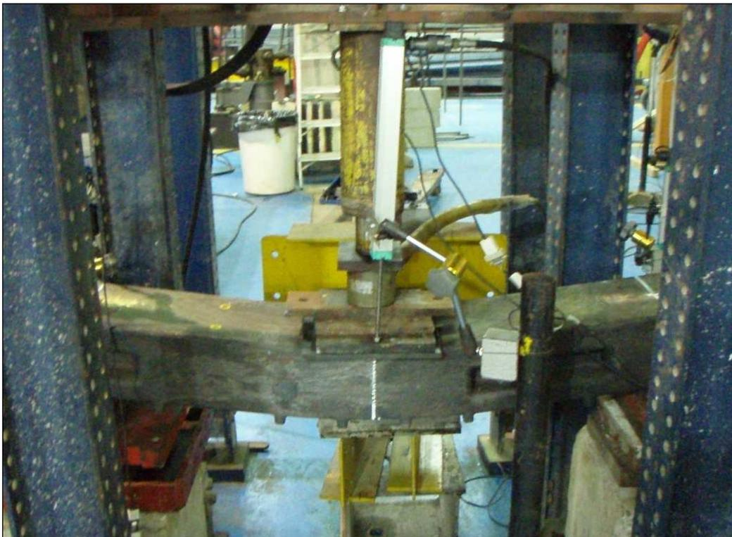
Figura 3-17 Aplicação da carga no dormente. Estágio avançado do ensaio de flexão no centro do vão do dormente D.P.1.1.E.F.1.C.5-1e.
