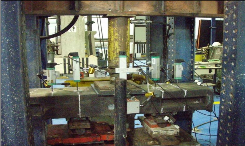
Figura 3-7 Montagem do ensaio de fluência.
