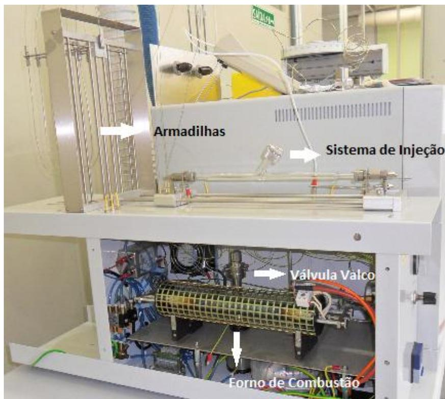
Figura 28 Equipamento PreCon usado na análise isotópica dos n-alcenos C<sub>1</sub>-C<sub>5</sub>
