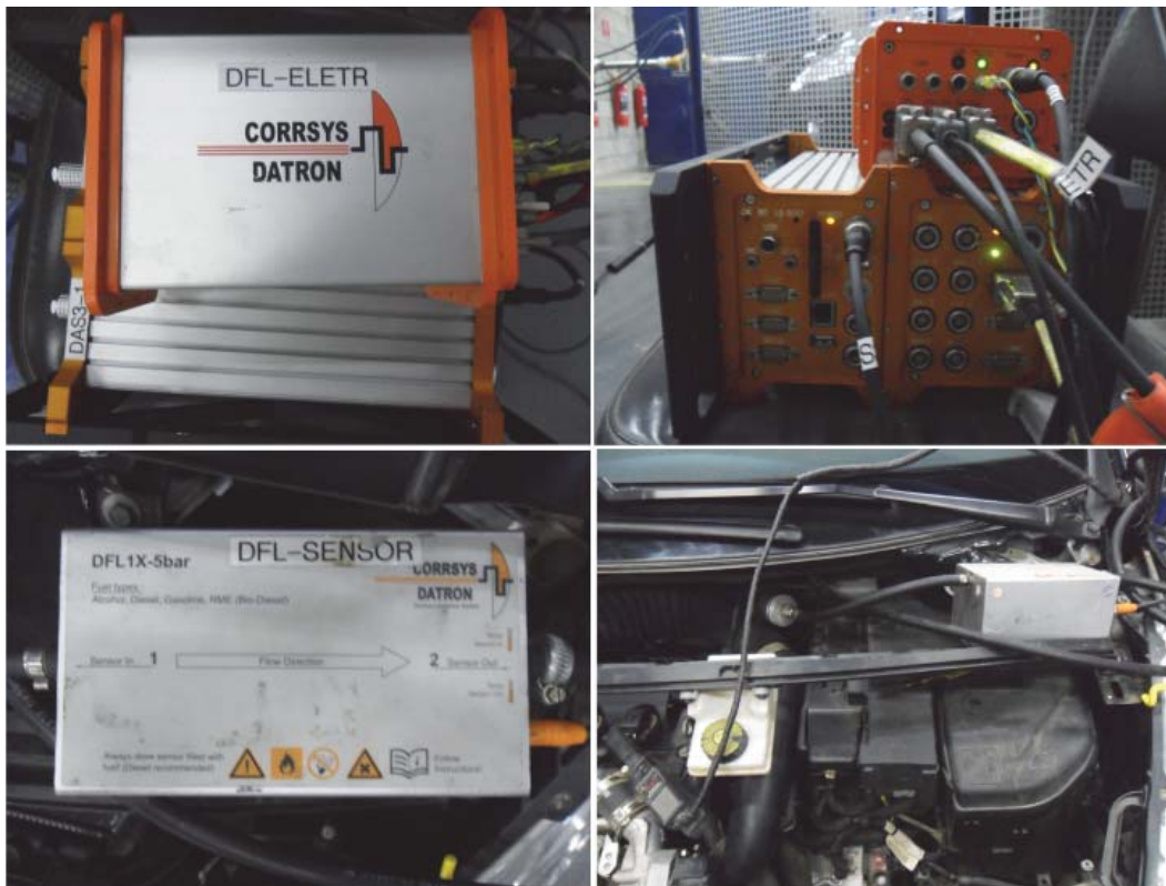
Figura 3.6: Sistema de Aquisição da Vazão de Combustível.
