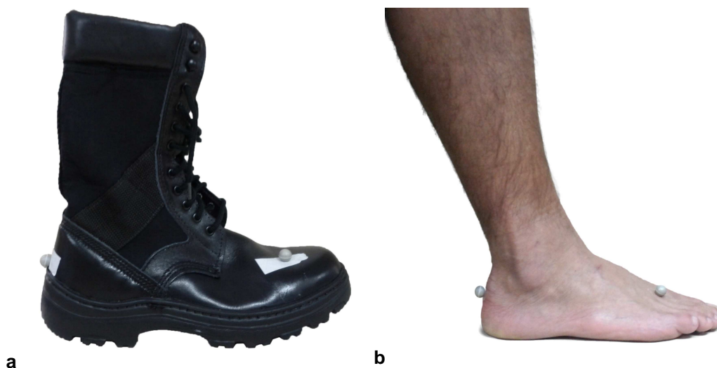
Figura 14. Localização dos marcadores passivos da cinemetria
