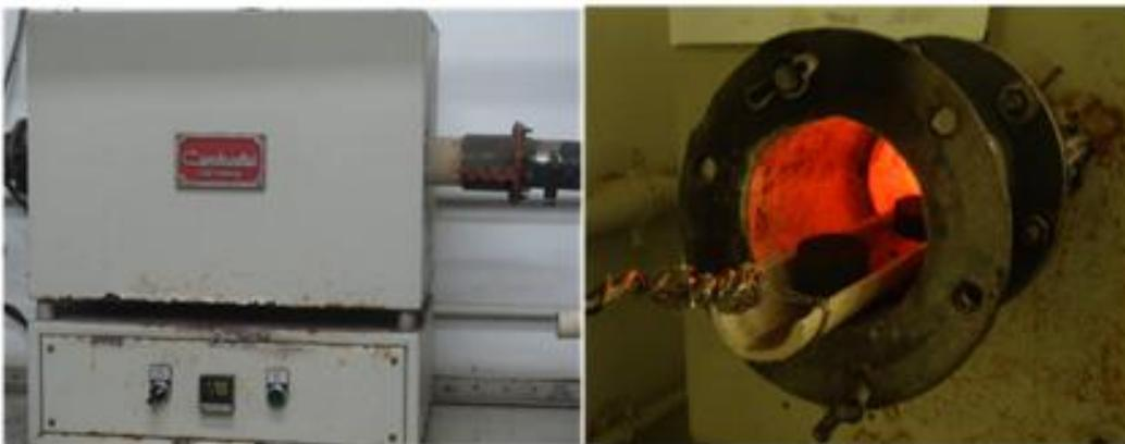
**Figura 31 - Forno Tubular (Esquerda); Amostras de carvão mineral colocada ao início no forno tubular (Direita).**
