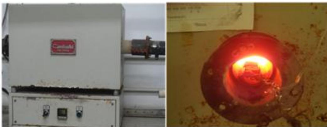
Figura 29 - Forno Tubular (Esquerda); Amostras de coque verde de petróleo colocada ao inicio no forno tubular (Direita)
