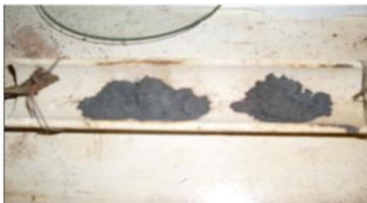
Figura 30 - Figura Coque verde de petróleo depois da saída do forno
