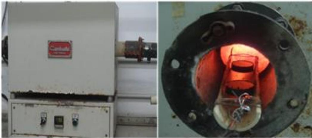
**Figura 35 - Forno Tubular (Esquerda); Amostras de coque metalúrgico colocada ao início no forno tubular (Direita).**
