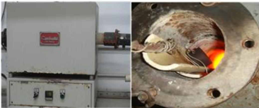
**Figura 33 - Forno Tubular (Esquerda); Amostras de carvão vegetal colocada ao início no forno tubular (Direita).**
