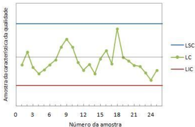
Figura 24 – Gráfico de controle \bar{x} com comportamento não aleatório Fonte: Montgomery (2004)
