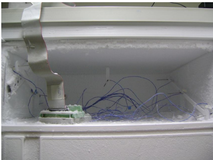
Figura 29: Posicionamento dos transdutores de temperatura no suporte regulável, para a realização da segunda etapa de medição de distribuição da temperatura no compartimento A do freezer 2.
