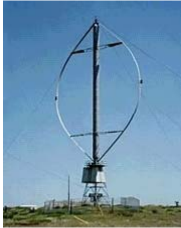
Figura 2-1 – Turbina eólica vertical Darrieus.
