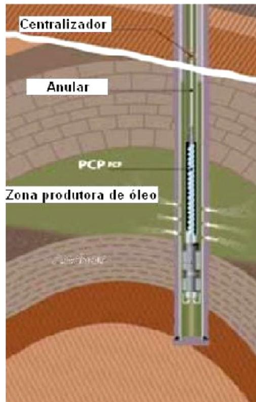
**Figura 4** - Esquema de canhoneio (Villarroel, 2009).
