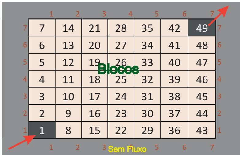
Figura 5.12: Representação esquemática da geração de uma malha 7x7 blocos de um reservatório.
