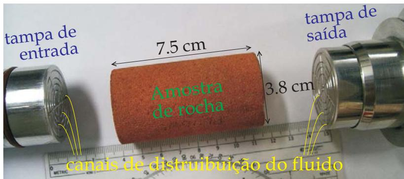
Figura 3.6: A amostra de arenito.
