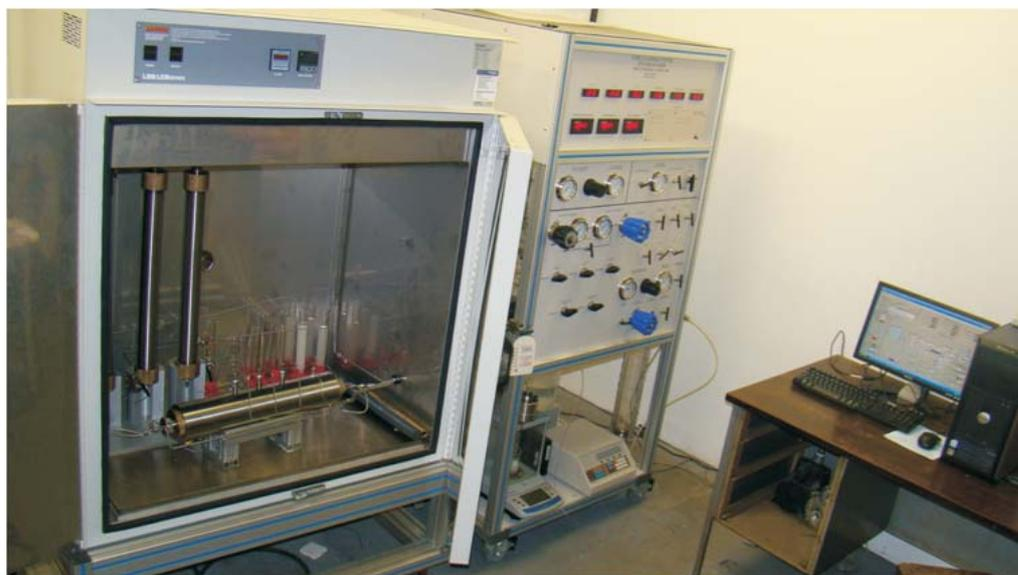
Figura 3.4: Fotografia do dispositivo experimental para o estudo do efeito do número de capilaridade no processo de deslocamento de óleo.
