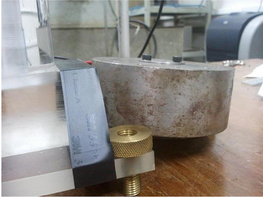
Figura 5.36 – Detalhe de pesos na base para evitar vibração
