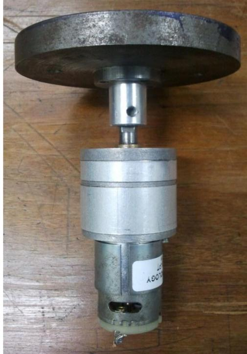
Figura 5.14 – Motor de redução com disco de ferro
