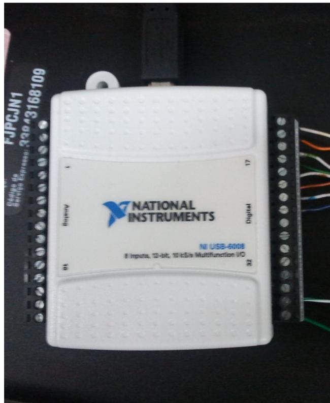
Figura 5.5 – Placa NI-DAQ, modelo USB-6008
