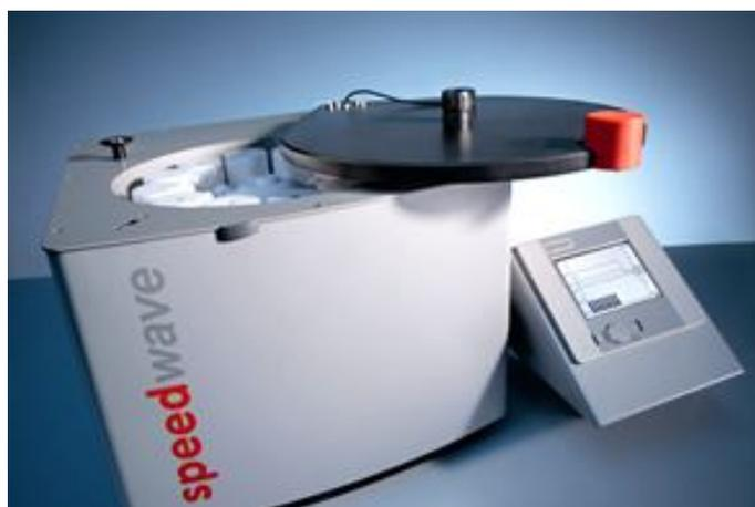
Figura 18 Forno de micro-ondas Speedwave Four – Labspectro / PUC-Rio
