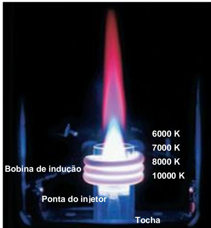
Figura 8 Plasma formado: Identificação dos componentes e regiões de temperaturas
