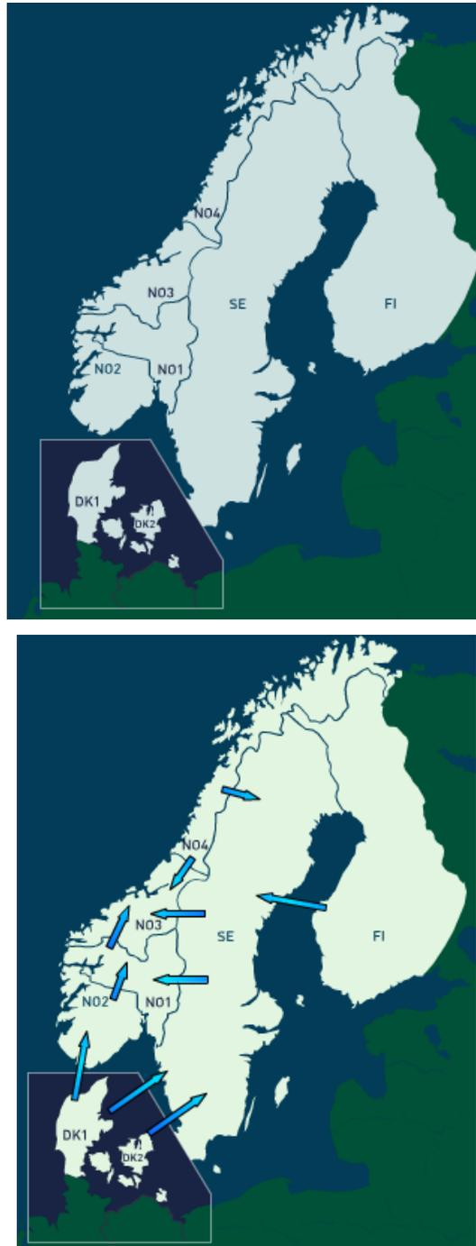
Figura 1.3 – Exemplo de divisão das áreas no Nord Pool e fluxos de energia
