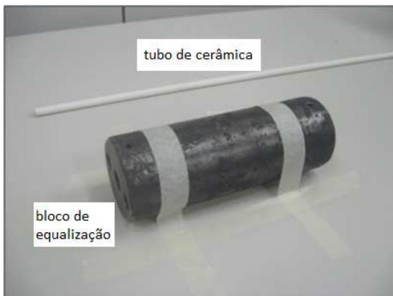
Figura 39: Fotografia do bloco de equalização e tubo cerâmico de proteção das fibras óticas.
