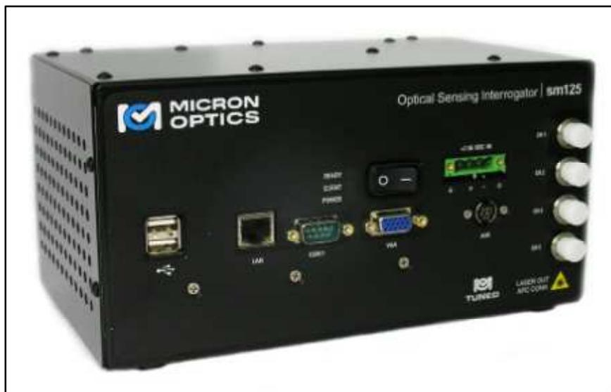
Figura 45: Fotografia do interrogador ótico Micron Optics modelo sm 125.
