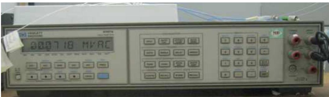
Figura 40: Fotografia do multímetro HP modelo 3457 A.
