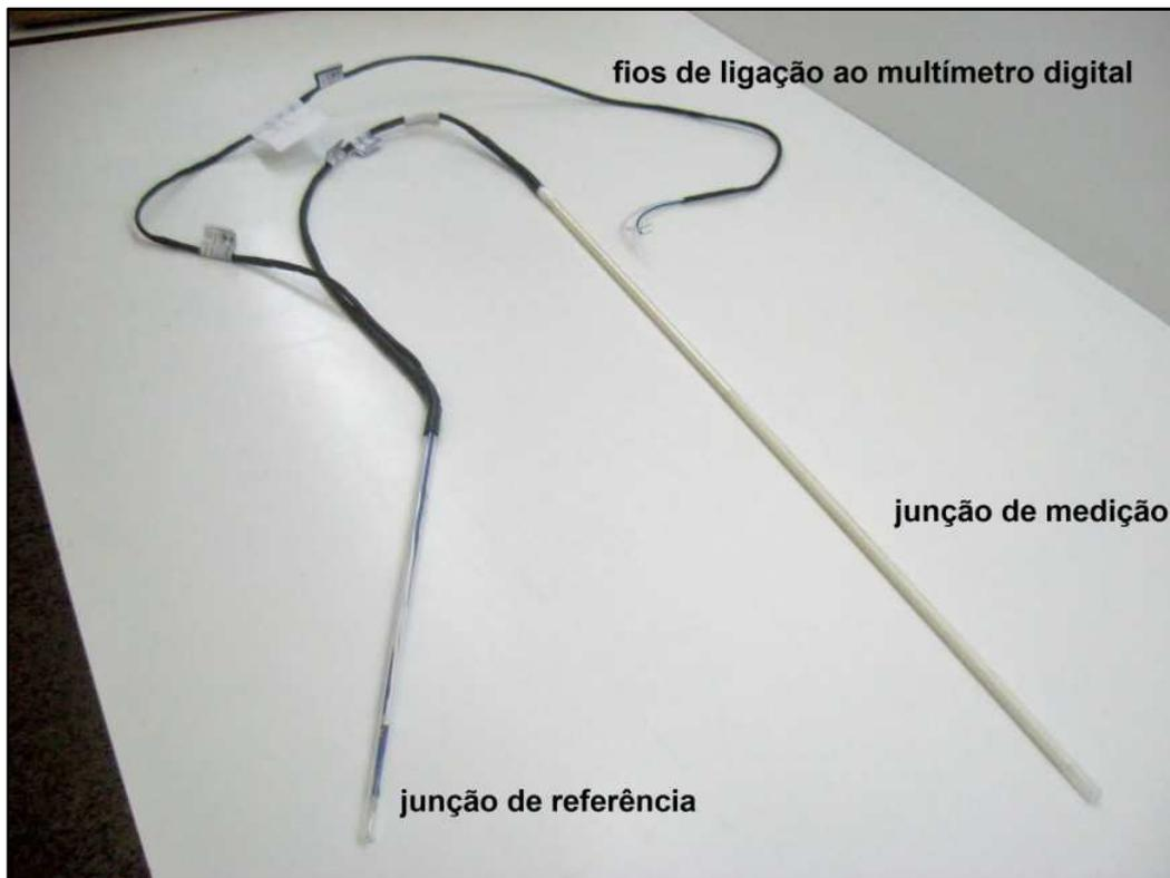
Figura 36: Fotografia de detalhes do termopar Au/Pt construído no Inmetro, onde se observa as junções quente e fria e os fios de ligação ao multímetro.
