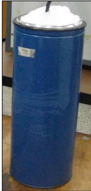
Figura 41: Fotografia do vaso Dewar preparado com gelo para a inserção do termopar Au/Pt de referência.
