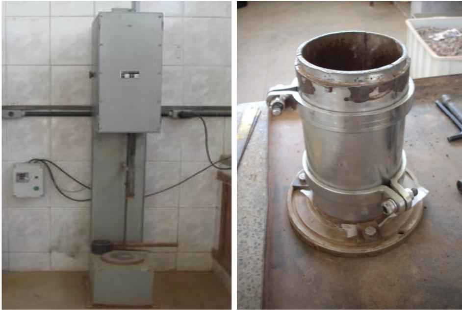
Figura 3.12 - Compactador Mecânico da COPPE/UFRJ e o molde tripartido utilizado.
