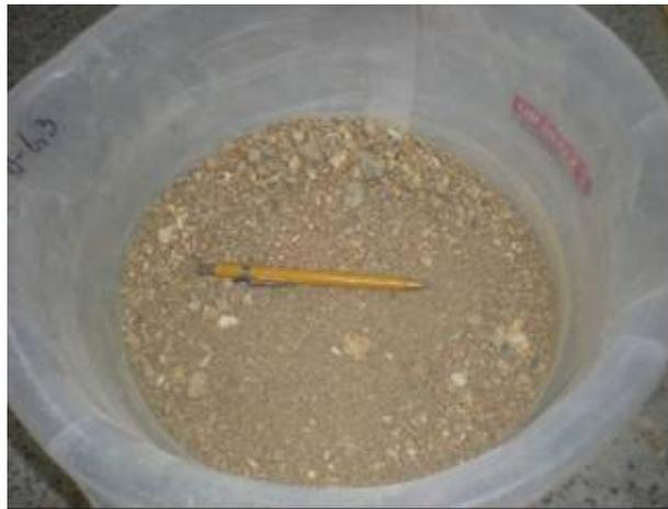
Figura 3.4 - Detalhe da amostra do Solo utilizado neste estudo após secagem e destorroamento
