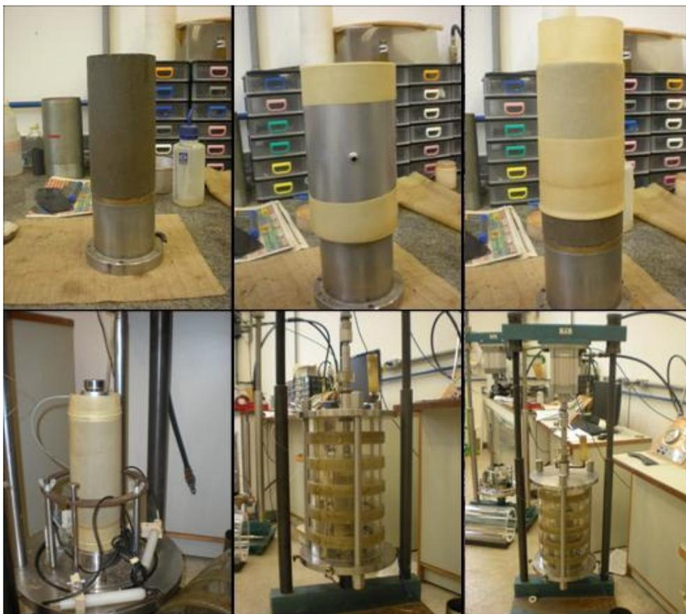
Figura 3.15 – Montagem do Equipamento do Ensaio Triaxial de Cargas Repetidas da COPPE/UFRJ (Fotos da autora durante esta pesquisa).
