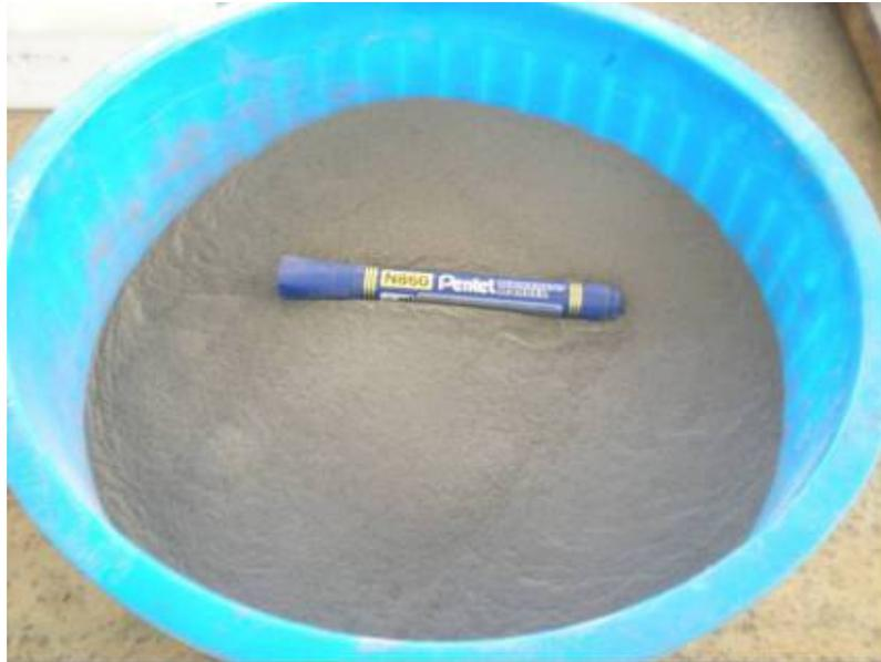
Figura 3.7– Aspecto da Cinza Volante utilizada no presente estudo
