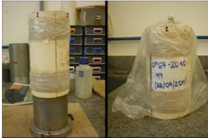
Figura 3.16 – Exemplo de Preparação dos corpos-de-prova após ensaio para Cura em Câmara Úmida desta pesquisa
