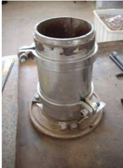
Figura 3.14 - Molde tripartido 10 X 20cm, para compactação dos corpos-de-prova.
