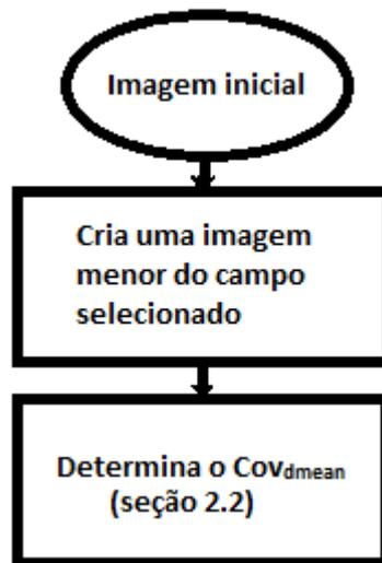
Figura 23 – Rotina para a determinação do  $Cov_{dmean}$  local.
