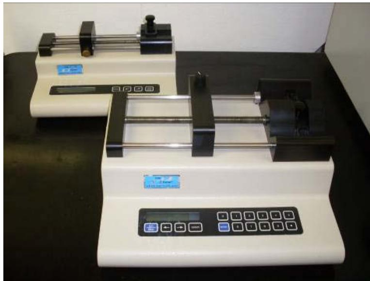
Figura 3.4: Bombas de seringa utilizadas Cole Parmer. O modelo 780100C foi utilizado para a injeção da fase contínua (bomba pequena) e o modelo 780200C para a injeção da fase dispersa (bomba maior).
