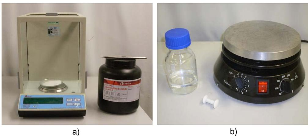
Figura 3.8: Procedimento de preparação das fases contínuas. a) Balança *QUIMIS* modelo *Q-500L210C* para a pesagem do surfactante dodecil sulfato de sódio. b) Agitador magnético *FISATOM 754A* com seu “peixinho” para a mistura água-surfactante.
