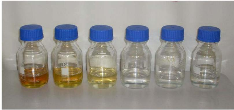
Figura 3.6: Diferentes fluidos utilizados como fases dispersas e contínuas. De esquerda a direita: Talpa 30, Velocite N°6, Óleo mineral OP3, Água com surfactante mais glicerina, Água com surfactante e Água.
