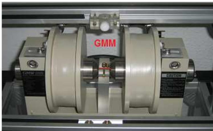
Figura 3-4. GMM posicionado entre os pólos do eletroímã para medir a resposta quando é aplicado um campo magnético uniforme.
