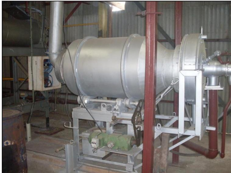
**Figura 44 – Forno rotativo**
