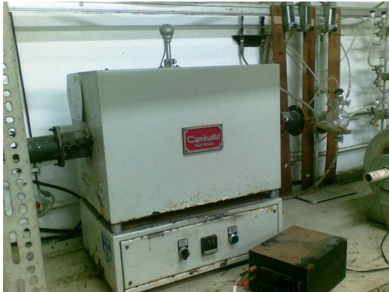
**Figura 51** – Forno (COMBUSTOL) utilizado para o ensaio de redução
