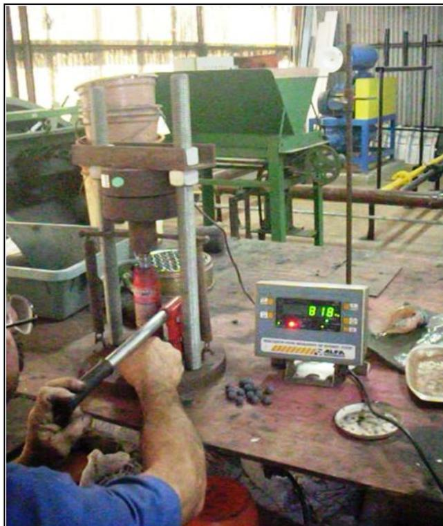
**Figura 49** – Equipamento para determinação da resistência à compressão das pelotas queimadas
