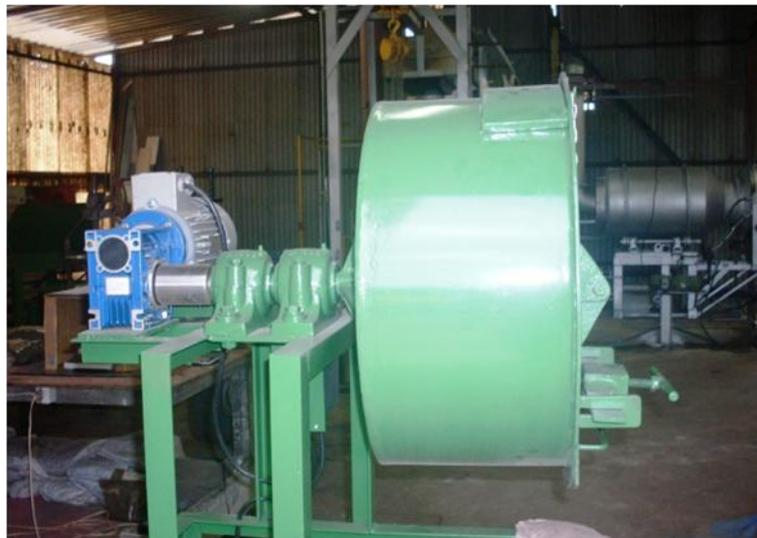
**Figura 50** – Equipamento para ensaio de abrasão e tamboramento
