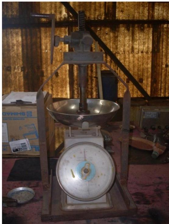
**Figura 48** – Equipamento para determinação da resistência à compressão das pelotas cruas
