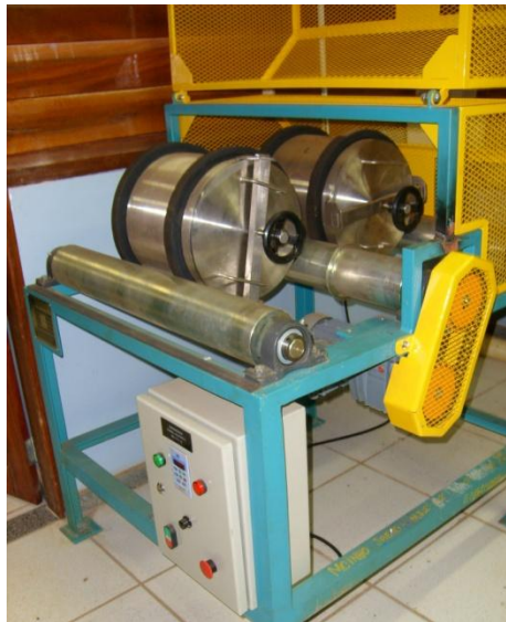
Figura 22 – Moinho para testes de índice de trabalho de Bond para moagem
