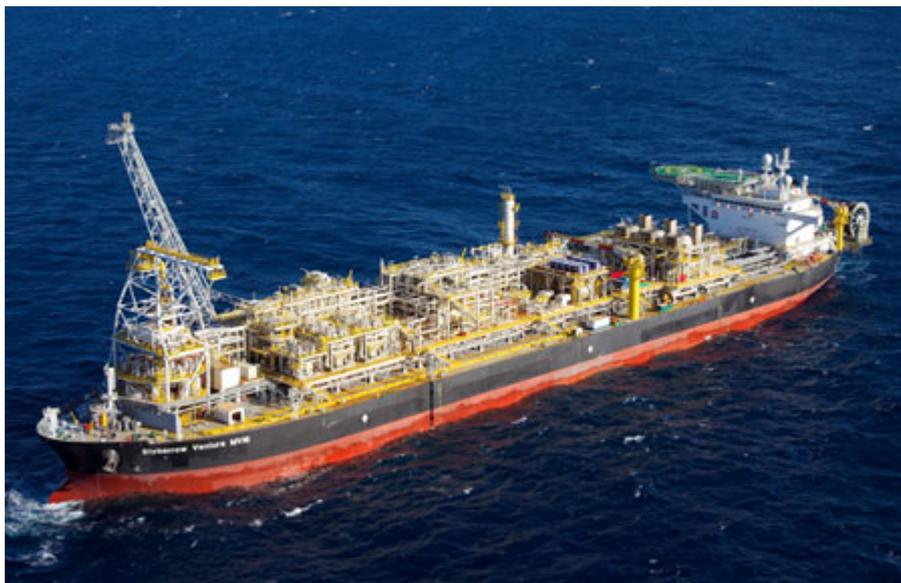
Figura 4: Unidade de Produção, Armazenagem e Transferência (FPSO)
