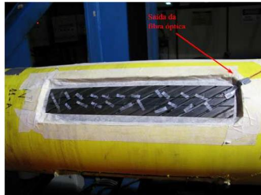
Figura 3. 15 - Detalhe da janela com o posicionamento da fibra óptica.
