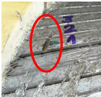
Figura 3. 10 - Detalhe do tipo de entalhe realizado sobre os arames.
