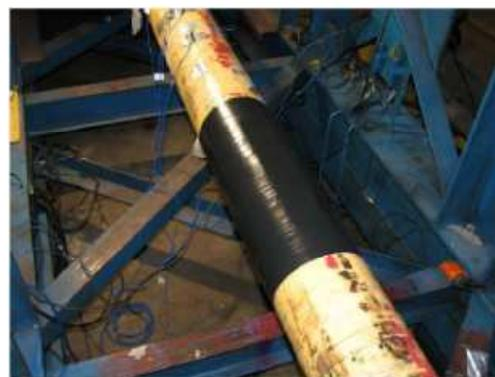
Figura 3. 6 - Amostra com o reparo após a instrumentação.
