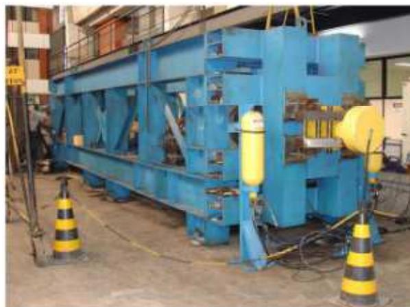
Figura 3. 4 - Máquina de tração utilizada no teste da COPPE/UFRJ.
