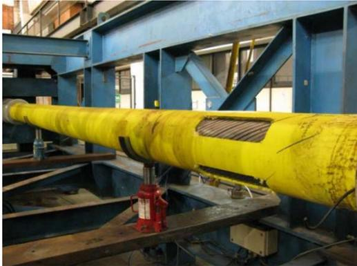
Figura 3. 14 - Janelas de instrumentação abertas sobre o duto de teste.
