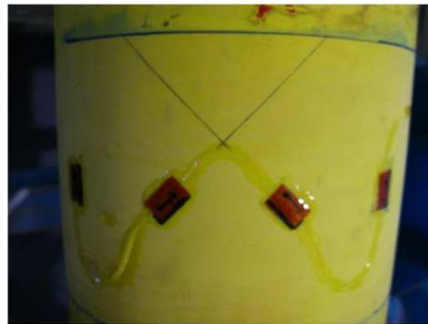
Figura 3. 20 - Sensores colados na capa com a utilização de uma película de Kapton.
