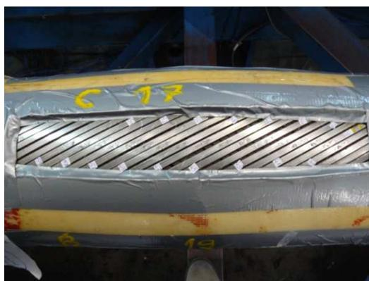
Figura 3. 9 - Janela de instrumentação aberta no *riser* de teste.
