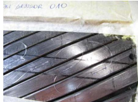
Figura 2. 13 - Rede de Bragg instalada sobre o arame.
