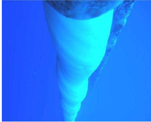
Figura 2. 2 - Torção e deformação da capa polimérica devido à ruptura de arames. [16]
