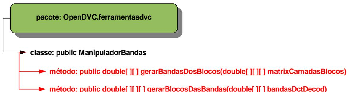
Figura 4.11 – Detalhamento da classe ManipuladorBandas
