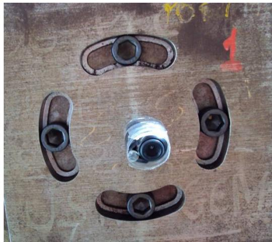
Figura 5.18 – Câmara filmadora e led de iluminação instalada na placa do atuador.
