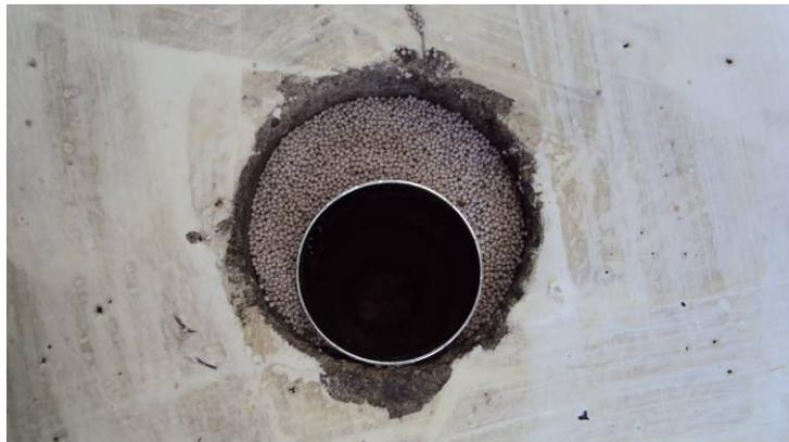
Figura 5.23 – Tubo encostado com o *gravel pack*.
