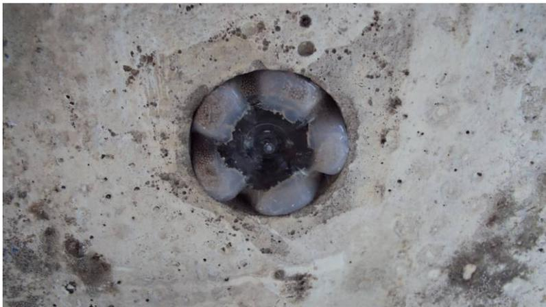
Figura 5.15 – Retenção do gravel pack nos extremos nos furos do bloco.
