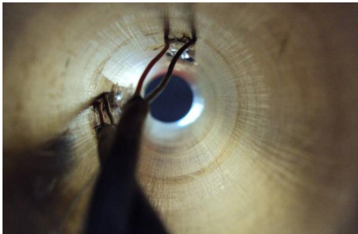
Figura 5.7 – *Strain gage* colados na superfície interna do tubo.
