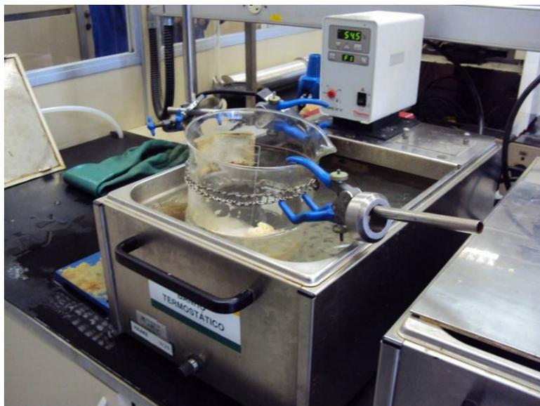
Figura 5.13 – Mistura de ácido esteárico e vaselina em banho termostático.
