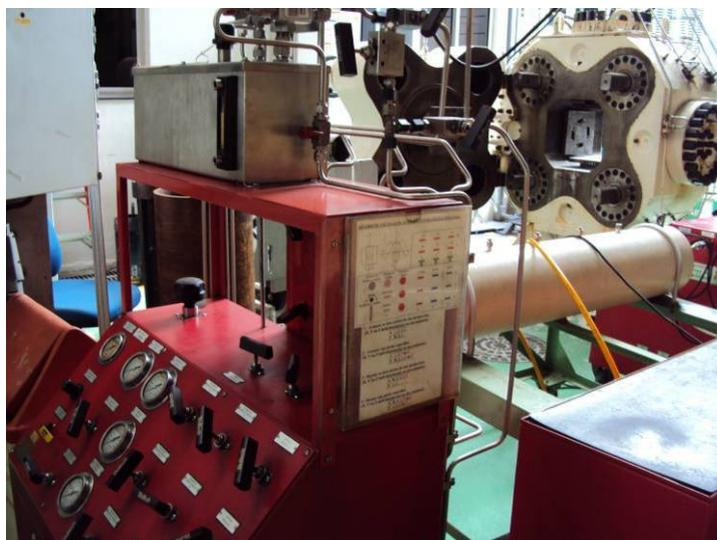
Figura 5.2 - Válvulas para acionamento da Célula Cúbica.
