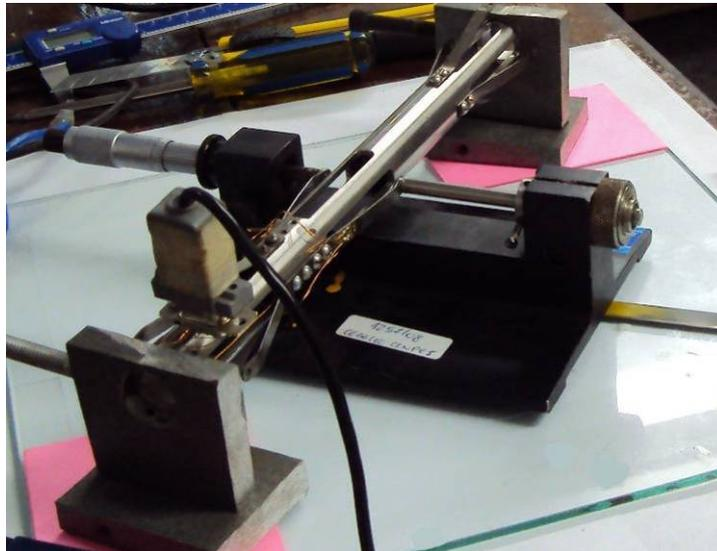
Figura 5.9 – 1º transdutor de deslocamento e dispositivo de calibração.
