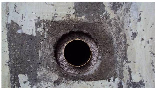
Figura 5.20 - Tubo centralizado com o *gravel pack* 16/20.
