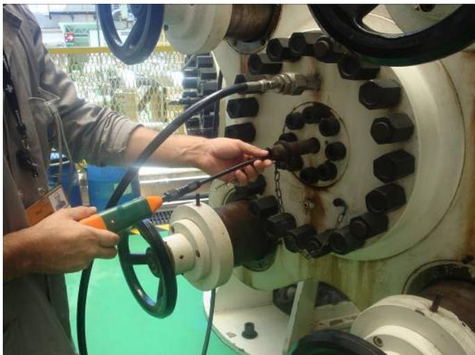
(a) – Passagem de câmara filmadora através de um conduto de 13 mm de diâmetro
