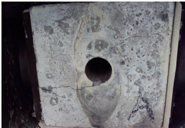
Figura 5.19 - Bloco fraturado depois de encostar os atuadores.
