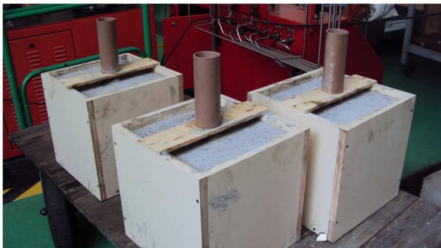
Figura 5.6 – Corpos de prova sintéticos com as respectivas formas.
