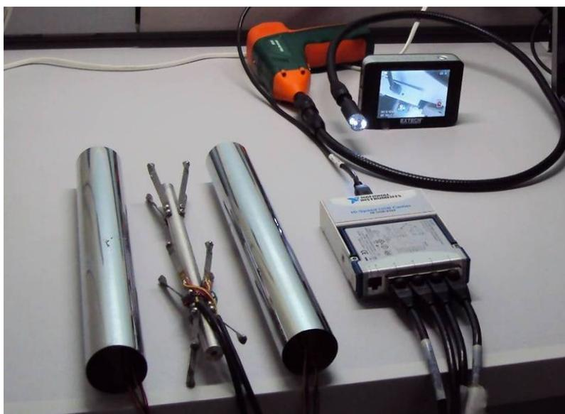
Figura 5.12 – Câmara filmadora Borescope, transdutor e tubos instrumentados.
