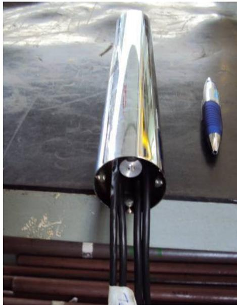
Figura 5.16 – Transdutor de deslocamento no interior do tubo instrumentado.
