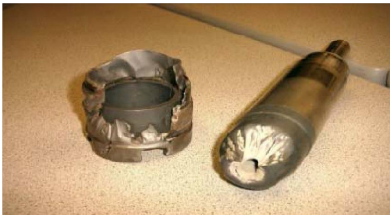
Figura 2.2 – Efeitos de erosão de choke , decorrentes da produção de sólidos (Da Silva, 2008).
