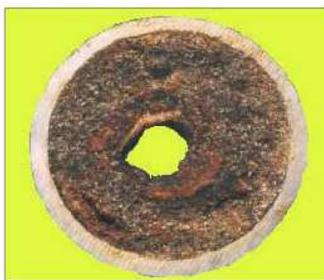
**Figura 1.2:** Bloqueio do duto por deposição de parafina. Cortesia do CENPES/Petrobras.
