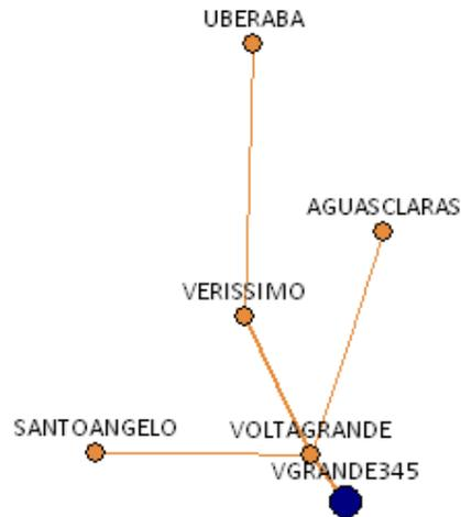
**Figura 5-34 – Volta Grande: diagrama unifilar da rede projetada**
