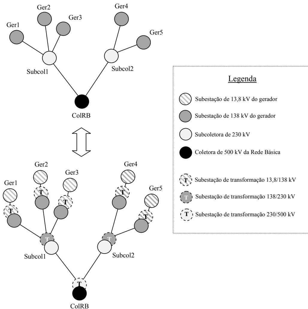
**Figura 3-1 – Representação implícita das subestações de transformação**
