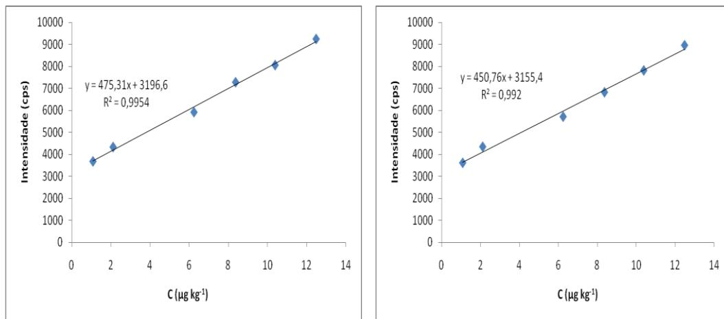
Curvas analíticas utilizadas na determinação de As no NIST 1634c para as replicatas analisadas:
