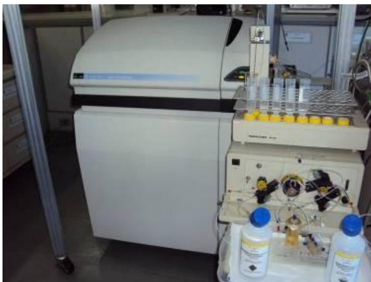
Figura 9: ICP-MS utilizado neste trabalho com o sistema FIAS acoplado.
