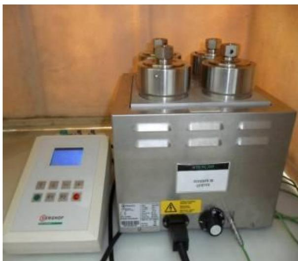
Figura 12: bloco de aquecimento/digestor DAB-3
