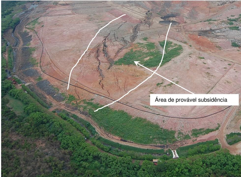
Figura 5.8: Provável escorregamento entre as seções 12 e 15 (retro-análise 4), 2010.
