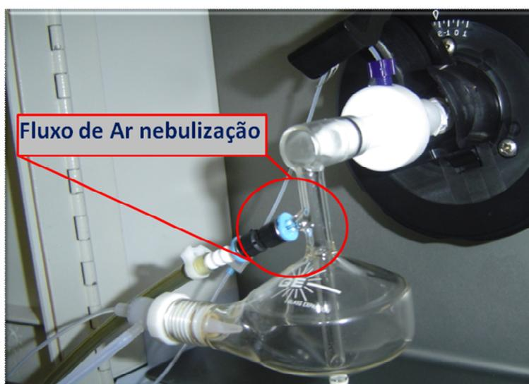
Figura 13: Ponto de adição de oxigênio ao fluxo de nebulização do ICP OES
