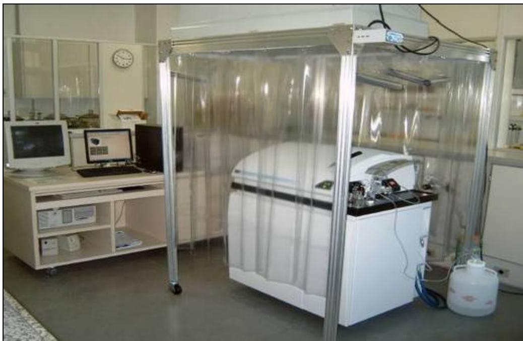
Figura 11: ELAN DRC II hospedado em câmara de fluxo laminar do Labspectro da PUC-Rio.
