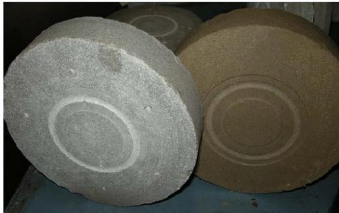
Figura 2.24: Mármore de Cartago na esquerda, e Calcário de Indiana na direita depois do teste de corte (Rafatian, 2009).
