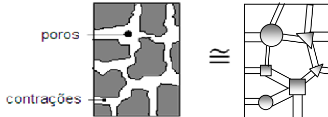
Figura 2.1 Arranjo básico de meio poroso e sua representação via modelo de rede
