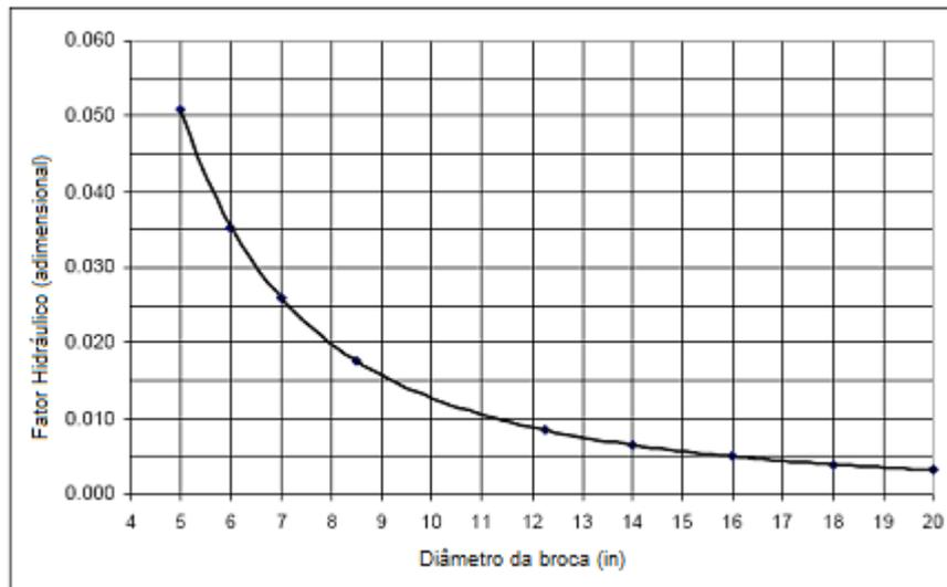
Figura 18 - Valores do fator hidráulico da broca (Modificado de Armenta, 2008).
