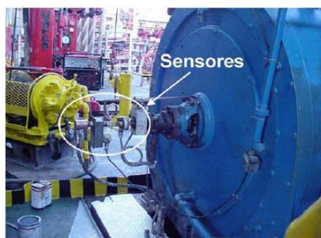
Figura 6 - Sensor de altura do gancho (Tavares, 2006).
