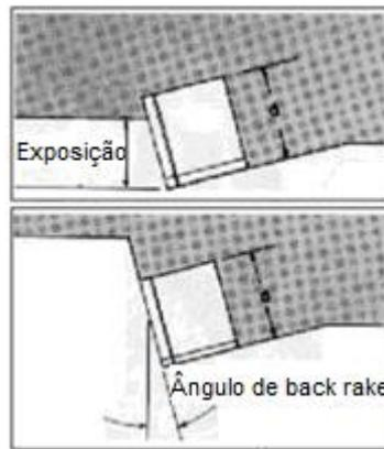
Figura 3 - Ângulo de ataque de um cortador PDC (Plácido e Pinho, 2009).
